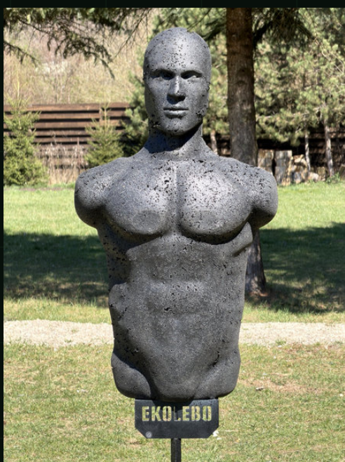
Testované tělo po 3 000 výstřelech: přední pohled.
